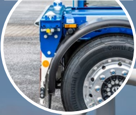
Tractionheck für optimalen Satteldruck
